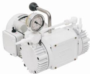
Bomba de vácuo modelo - 826T com resistência a solventes, fabricada com diafragma em PTFE capacidade de vácuo até 15 mbar.
