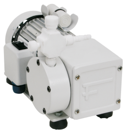
Bomba de vácuo modelo - 821T com resistência a solventes, fabricada com diafragma em PTFE capacidade de vácuo até 130 mbar.
