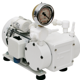
Bomba de vácuo - modelo 822T com resistência a solventes, fabricada com diafragma em PTFE capacidade de vácuo até 30 mbar.
