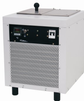
Banho termostatizado com refrigeração e circulação externa - modelo 861 - Para refrigeração do condensador. Refrigera ou aquece, possibilita circulação interna ou externa, cuba 9 litros, controle de temperatura de -20 a 95 °C. Pode ser utilizado com o evaporador rotativo
